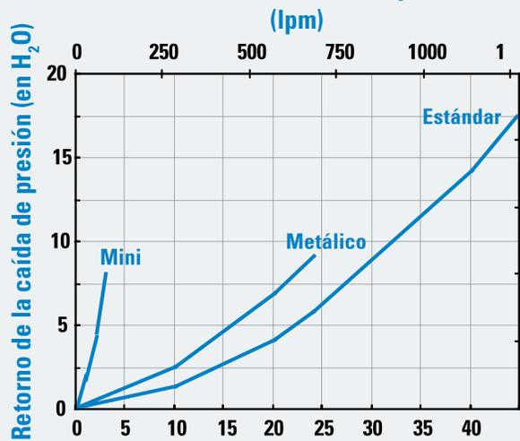
Coloque el respiradero T.R.A.P. según la tasa de intercambio de fluidos, no el tamaño del depósito.
